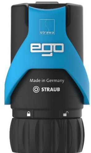
Aufgrund seines Kondensatornetzteils stellt der EGO eine kapazitive Last dar. Alle vorgeschalteten Aktoren (bspw. Raumregler oder Klemmleisten) müssen dafür geeignet sein.
